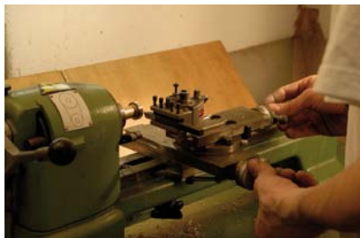
Etape 3 Fraisage des alliances à l'outil diamant et mise en pierre avec diviseur pour une plus grande précision.
