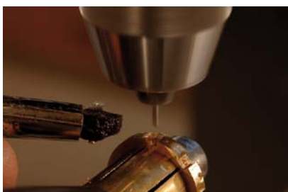
Etape 2 Tournage des pièces à l'outil diamant.
